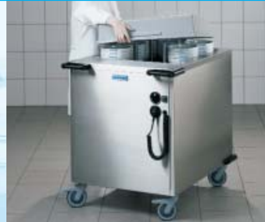
Bühnenstapler BDUH/60-60/4-S (umluftbeheizt). Einstellbare Geschirrsäulenführung durch Stäbe, 4 davon im Lieferumfang enthalten. Einfache Anpassung an alle gängigen Geschirrgrößen zwischen beispielsweise Ø 170 mm und Ø 280 mm durch spezielles Bodenraster mit 7 x 7 = 49 Steckplätzen.
