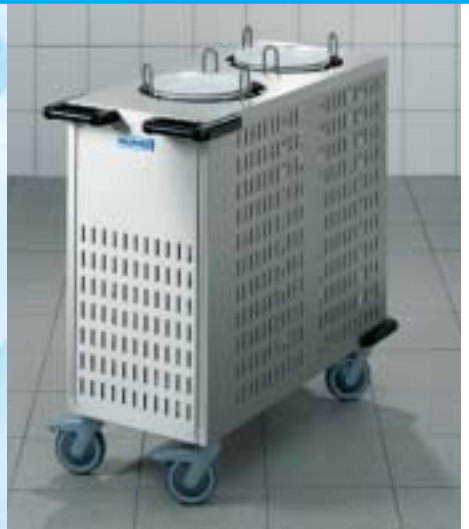
Tellerstapler TE-2/VK 19-26 (unbeheizt). Speziell geeignet zum Portionieren gekühlter Speise- komponenten in Cook & Chill-Küchen. Die Kühlschlitze sorgen für einen schnellen Austausch der zunächst warmen Stapleratmosphäre mit der umgebenden kalten Luft des Kühlhauses und bewirken so eine gleichmäßige Kälteverteilung im Geschirr. Ein weiteres Einsatzgebiet ist die Portionierung von Kaltkomponenten für die vorgezogene Abendverteilung und das Frühstücksgeschäft in Cook & Serve-Küchen.
